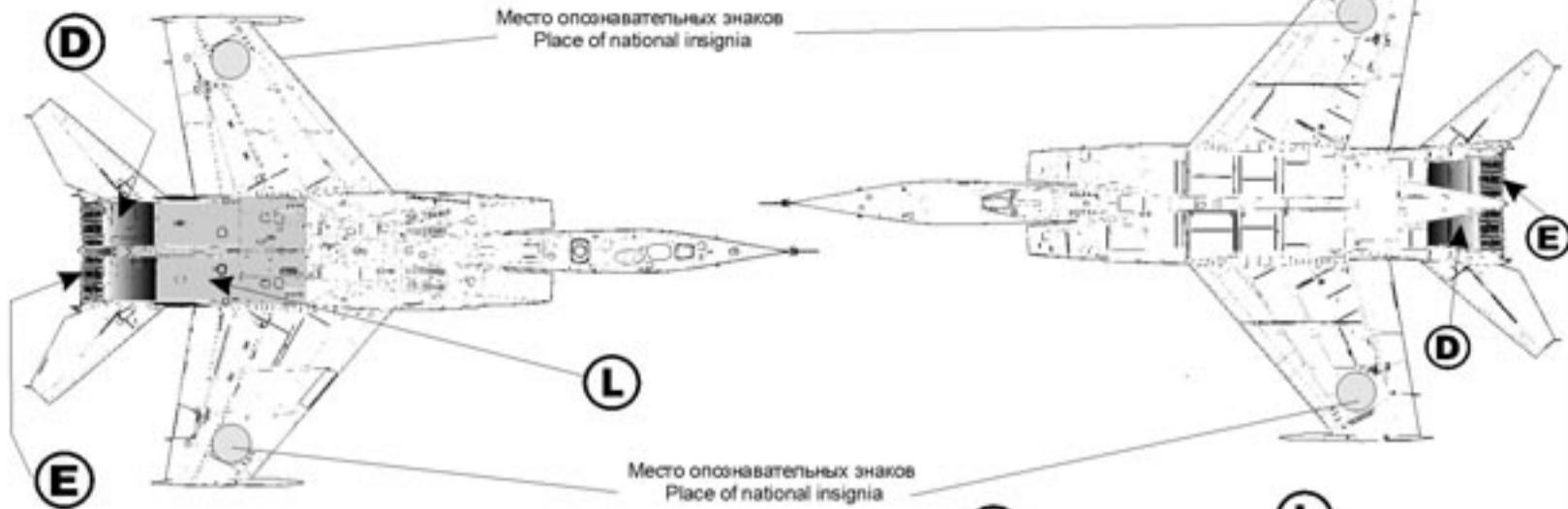
На большинстве МиГ-25 всех модификаций помимо жаропрочных экранов отчетливо выделяются стальные неокрашенные капоты двигателей на верхнихбоковых и нижней поверхности фюзеляжа. На некоторых МиГ-25 капоты закрашены в цвет низа фюзеляжа, на большинстве нет.
